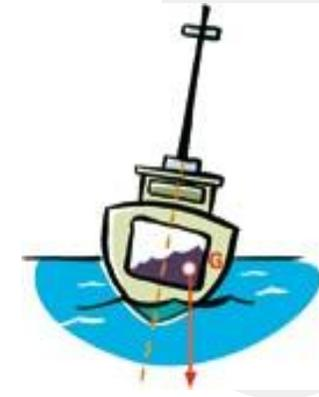
**L'EFFETTO SPECCHIO LIBERO AUMENTA IL RISCHIO DI RIBALTAMENTO.** Il baricentro si sposta lateralmente, riducendo la stabilità dell'imbarcazione. Per limitare al minimo l'effetto specchio libero si deve limitare il più possibile il numero di compartimenti o di serbatoi parzialmente riempiti.
