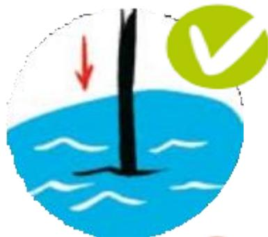
Lasciare **SEMPRE** che la fune del verricello tocchi l'acqua prima di afferrarlo per scaricare l'ingente carica elettrostatica accumulatasi.
